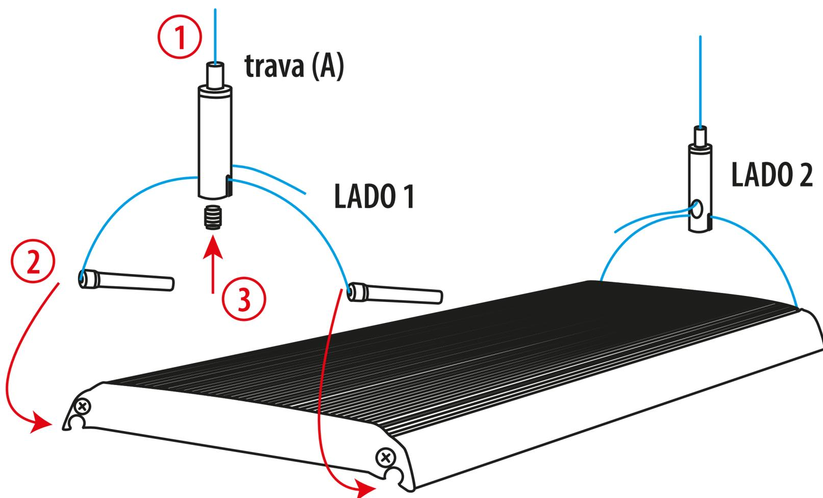
Para instalação do kit de suspensão conforme a figura acima.
