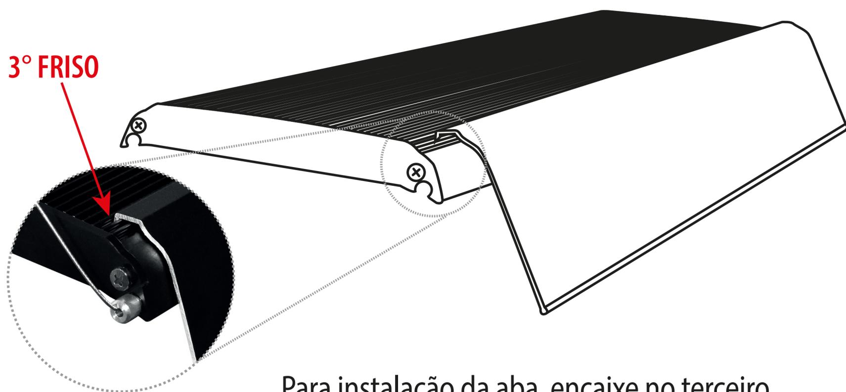
Para instalação da aba, encaixe no terceiro friso (canal) conforme a figura acima.
